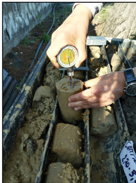
Prova con penetrometro tascabile -4.20 m, 5.6-4.6-5.0 Kg/cm 2
