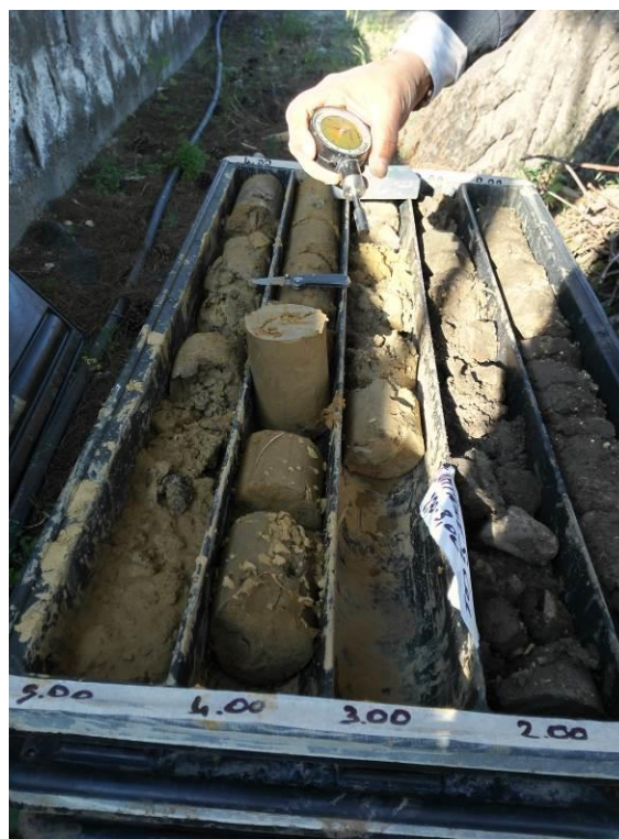
- Prove con Pocket Penetrometer -
